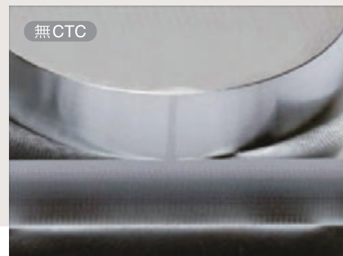
CTC補償刀具中心 因加速度所造成的位置誤差
