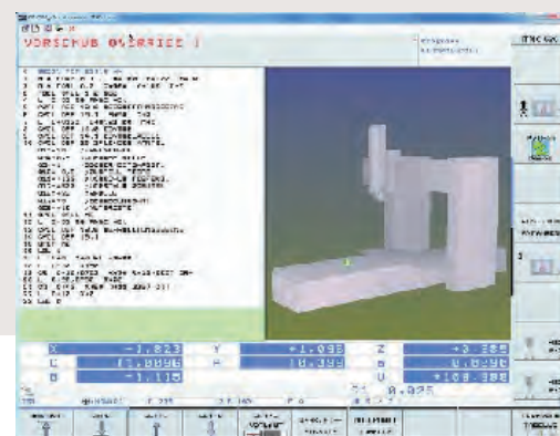
動態碰撞監控-DCM 有效防止因程式錯誤與人為疏忽所造成的機台碰撞
